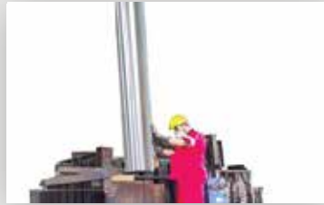
طلاء كروم للأعمدة حتى طول 11 م حتى سماكة 45 سم للقطر الخارجي
