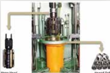
تنعيم أسطوانات حتى طول 6.5 م و45 سم قطر داخلي
