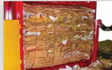
نسبة حجم تقليل البالة 10:1 Reduction in volume ratio of 10:1
