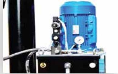
وحدة الهيدروليك Power pack
