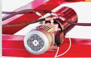
وحدة الهيدروليك Power pack
