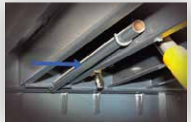
عمود أمان لتثبيت المنصة أثناء الصيانة Safety bar for maintenance work
