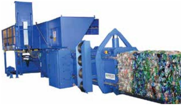
المكبس الأفقي مناسب تمامًا لضغط المواد القابلة لإعادة التدوير في بالات ثابتة وعالية الكثافة. يتم ضغط المواد بواسطة لوح ضغط مثبت أفقيًا يتم تشغيله بواسطة محرك كهربائي هيدروليكي. هذا يضمن التعبئة المستمرة للآلة، ويتم ضمان تكامل عملية الإنتاج.
