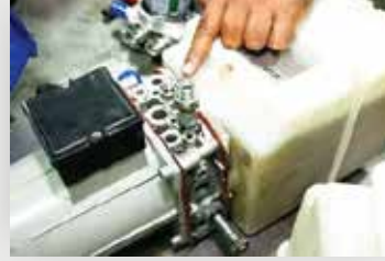
إصلاح وحدة الهيدروليك Repair of power pack
