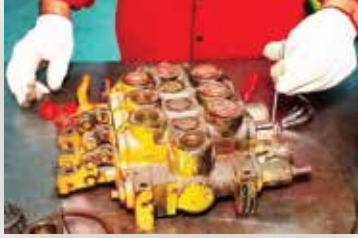
القدرة على إصلاح و اختبار جميع أنواع المضخات و المحركات و الصمامات Repair of control valves
