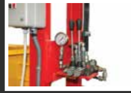
صمام يدوي للتحكم Manual control valve
